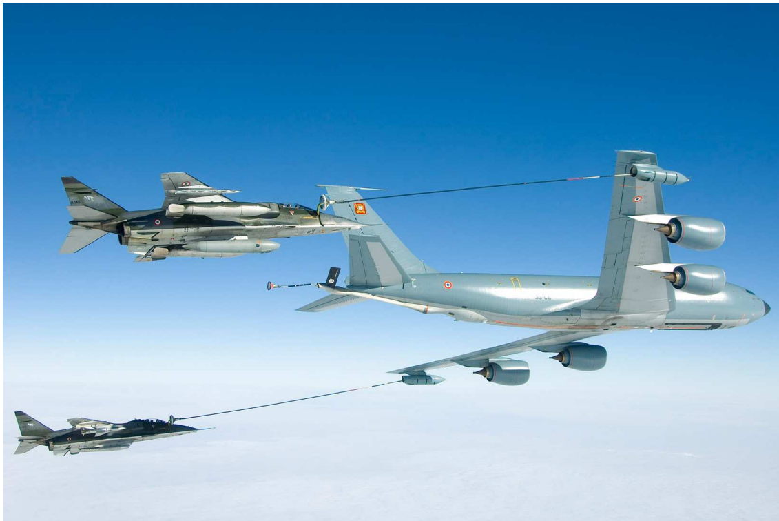
Illustration de la solution ; deux chasseurs Jaguar A en ravitaillement auprès d'un C-135 FR. Ref.010
