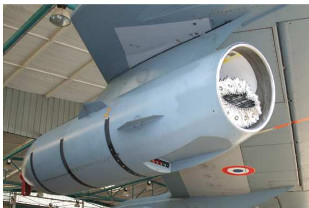
La nacelle de ravitaillement est fixée à l'avion ravitailleur via un plot qui facilite la maintenance du pod. Ref.013
