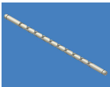
Etape 4 : construction de la seconde hélicoïdale inversée
